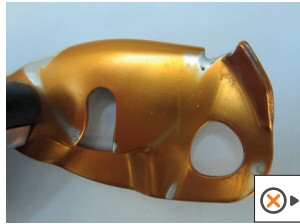
• Uszkodzona okładka ruchoma
