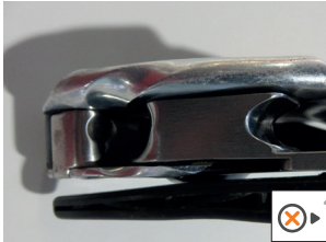
• Zniszczony kanał liny
